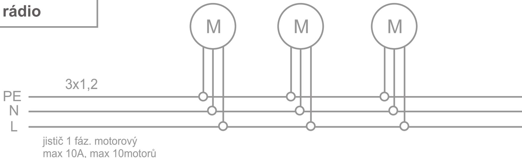
Kabely na motoru: Motor bez přijímače RTS - 4 žíly (žlutozelená, modrá, hnědá, černá)
