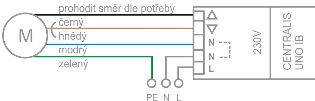
Motor s přijímačem RTS - 3 žíly (žlutozelená, modrá, hnědá)
